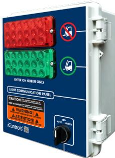
Un panel de control montado en pared con luces rectangulares rojas y verdes de 18 LED de alta visibilidad y entradas de terminal para un interruptor de límite o de proximidad de 24 Vcc y un semáforo exterior LED Stop & Go de 24 Vcc. Las luces se pueden cambiar manualmente o controlar mediante un interruptor conectado (no incluido) en modo "Auto".
